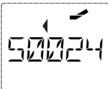
Premendo il "tasto freccia" destro, ha luogo la commutazione dello scambio. In base all'azionamento dello scambio impiegato viene emesso eventualmente un segnale acustico. Le posizioni libere tra "S" e l'indirizzo "24" sono compilati con "0".
