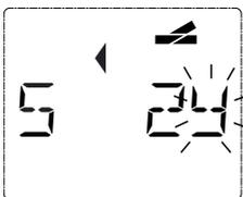
Il contrassegno di immissione lampeggiante segnala la possibilità di immettere l'indirizzo dello scambio. Attraverso i "Tasti funzione" "2" e "4" immettere l'indirizzo "24".
