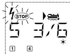
Se si tratta di un corto circuito ad es. a causa di un vagone o un treno deragliato è necessario risolvere il guasto.
