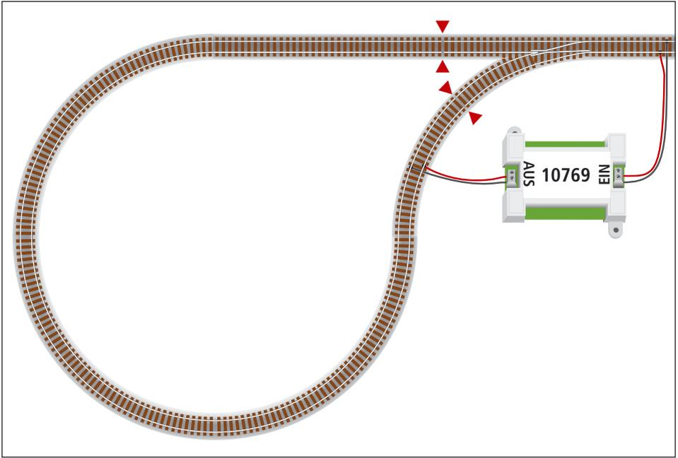
Eine digitale Kehrschleife mit dem [Kehrschleifenmodul 10769](#).
