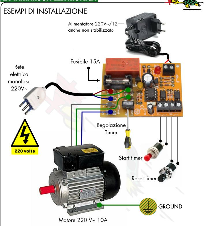
Premendo il pulsante rosso collegato all ingresso P1 si attiva il relè che comanda il motore elettrico che rimane acceso per il tempo impostato con il trimmer RV1. La pressione del pulsante nero collegato all ingresso P2 interrompe il ciclo prima dello scadere del tempo prefissato da RV1.
