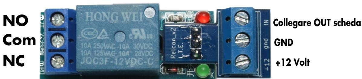
Il contatto pulito dell'uscita relè può essere usato per l'attivazione di altri dispositivi di segnalazione, quali Campanelle leopolder + temporizzatore (Art.1802) (Art.1061), scheda MP3 Suoni di Ferrovia (Art.1500).
