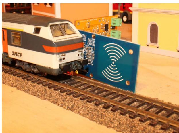
**Posizionare lateralmente l'antenna RFID-Sound e sempre verso il lato in cui è stato inserito il micro-TAG RFID**
