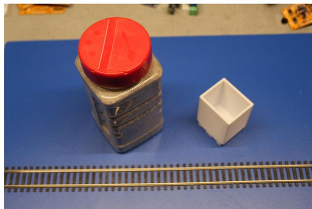
Si posiziona il BALAST sul binario e lo si riempie con i sassi per la massicciata
